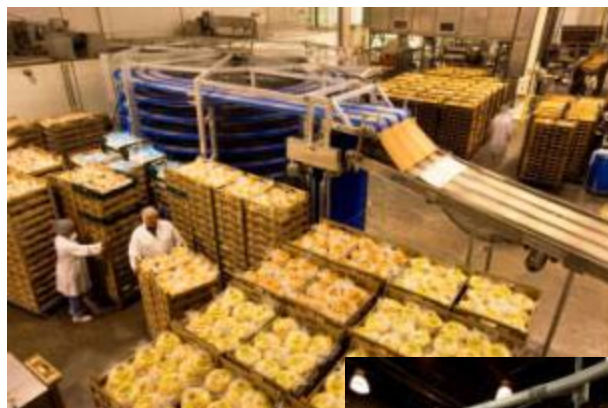
La nouvelle chaîne de production de pain pita réduit le temps de cuisson, utilise moins d'énergie et est à moitié plus courte que l'ancienne. Photo gracieusement fournie par Fancy Pokket.
