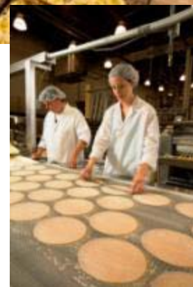
La nouvelle chaîne de production de pain pita réduit le temps de cuisson, utilise moins d'énergie et est à moitié plus courte que l'ancienne. Photo gracieusement fournie par Fancy Pokket.
